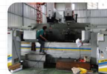
雙頭皆搭配獨立滾珠螺桿，共用同一個工作槽。相較於兩部工具機，更可以節省占地面積，且價錢更為划算。
